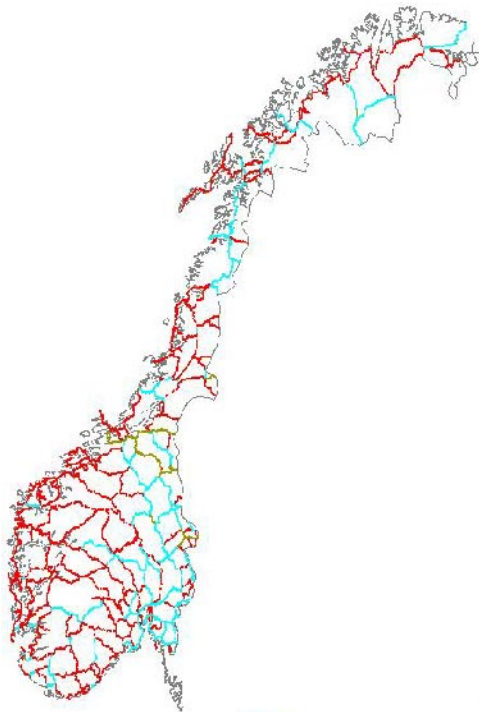
Figur 4 Norges 1. ordens nivellementsnett. Rødt: Målt en gang. Blått målt 2 ganger. Grønt målt tre ganger
